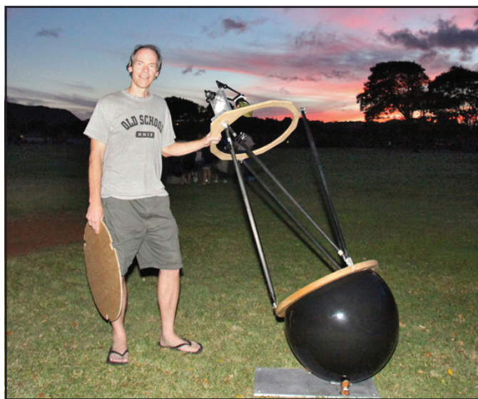
Mike Linnolt (LMK) avec son télescope de Newton à monture sphérique de 500 mm f/3,6 de fabrication personnelle.
