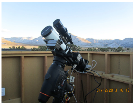
Dwa z teleskopów sieci AAVSONet: BSM-Hamren, 65mm refraktor Astro-Tech AT-65EDQ (po lewej) oraz Coker 30, teleskop Meade LX-200GPS o średnicy 30cm (po prawej)
